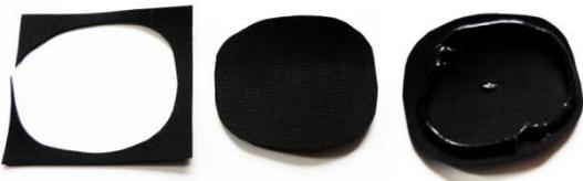
Isecite i očistite parče folije koje treba da bude dovoljne veličine da može da preklopi oštećenje sa svih strana za oko 5 cm. Nanesite lepak i ravnomerno ga razmažite četkicom u tankom sloju na obe površine koje treba zalepiti.
